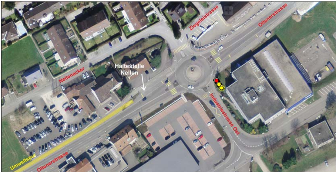
[Lichtsignalregelung in der Kreiselzufahrt Industriestrasse Ost]
