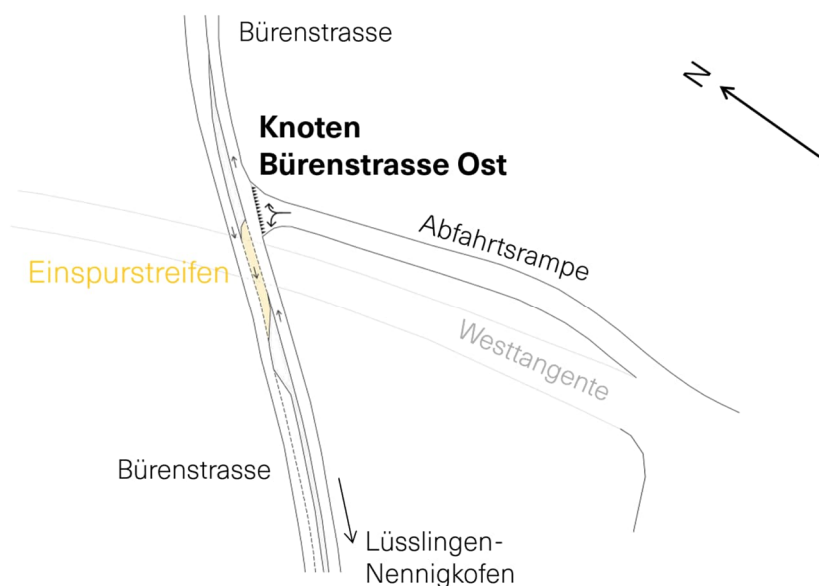
Abbildung 2: Ausgestaltung neuer Knoten Bürenstrasse Ost
