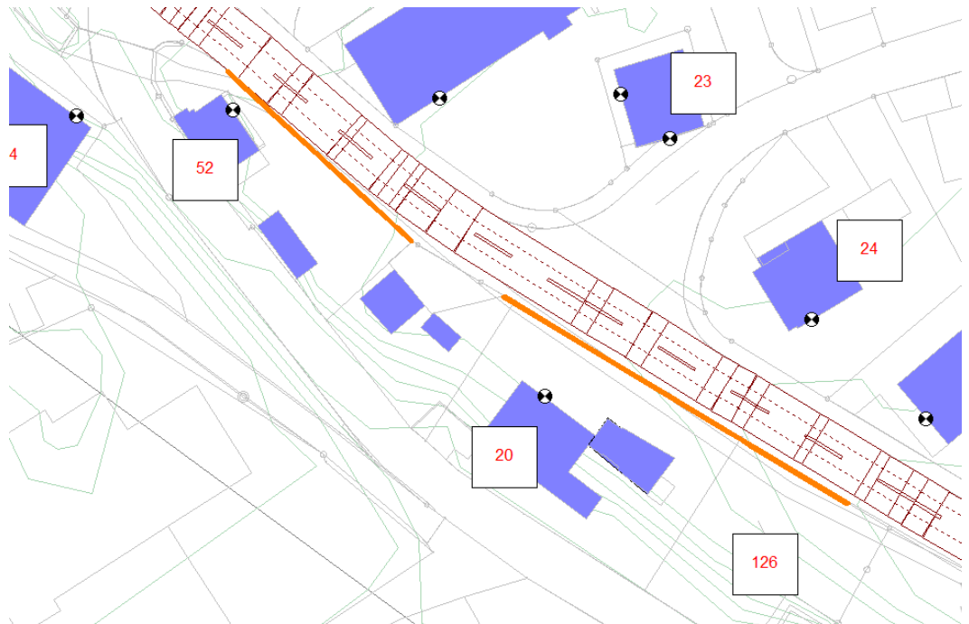
Abbildung 2: Ausschnitt aus dem Lärmmodell (Programm CadnaA) mit Lage der gemäss kantonalem Erschliessungsplan geplanten Lärm- bzw. Sichtschutzwände (orange)
