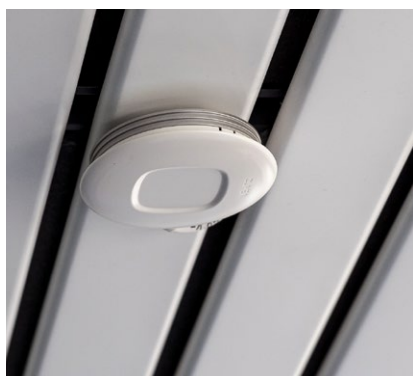
Diskret und kaum sichtbar. Der Radar-Sensor wird an der Decke angebracht und überträgt die Daten auf den Server.
