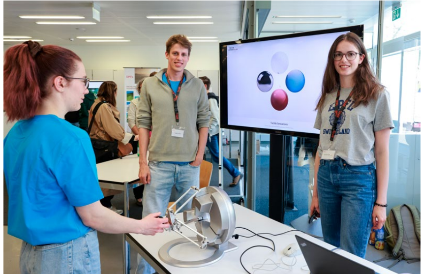
Dieser Simulator ermöglicht es, Oberflächenstrukturen und Materialbeschaffenheit mit der eigenen Hand zu spüren. Quelle: EPFL / Alain Herzog
