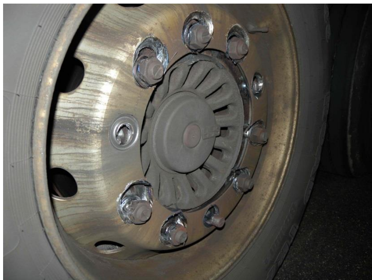
Dieses Rad eines Sattelmotorfahrzeugs drohte abzufallen. Die Felge war ausgeschlagen, 3 Radmuttern fehlten.
