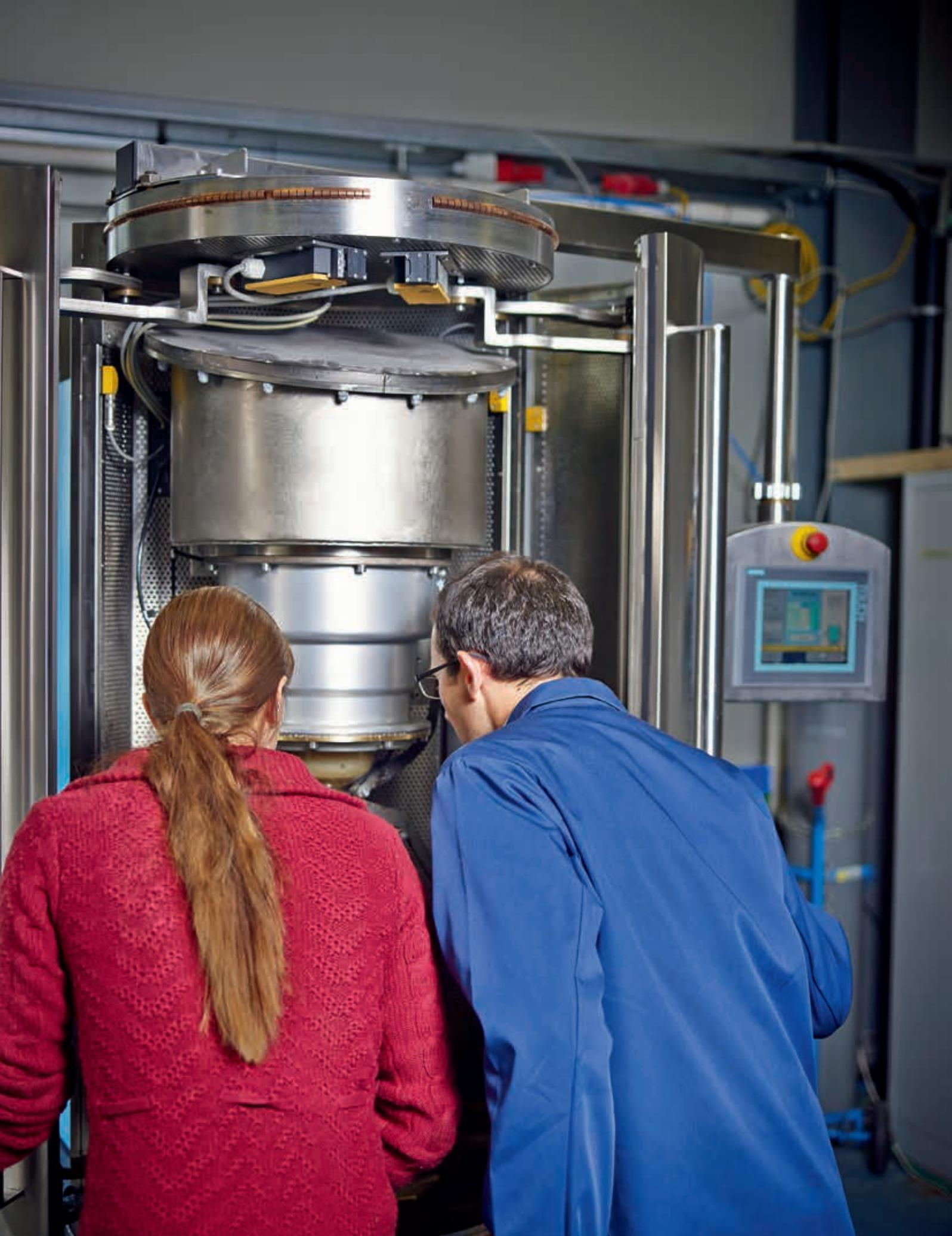
Durch Hochspannungsentladungen zerlegt eine Anlage der Firma Selfrac AG Kunststoffteile, um daraus Fasern für die Forschungsversuche der FHNW zu gewinnen.
