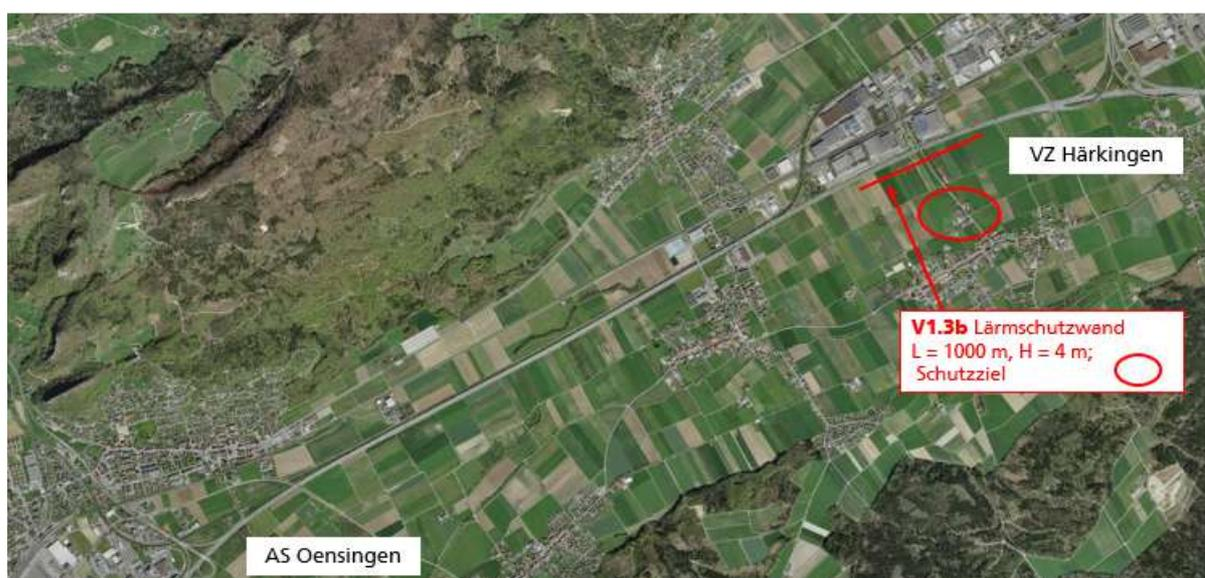
Abbildung 7: Neubau Lärmschutzwand Neuendorf Süd (V1.3b)
