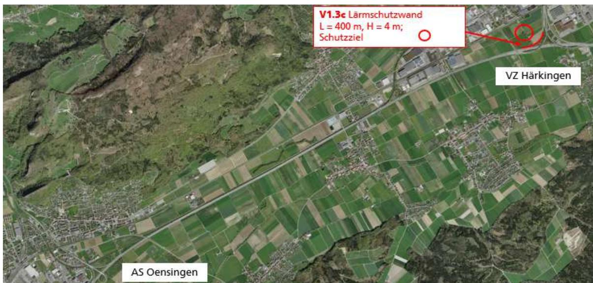
Abbildung 8: Neubau Lärmschutzwand Neuendorf Nord (V1.3c)
