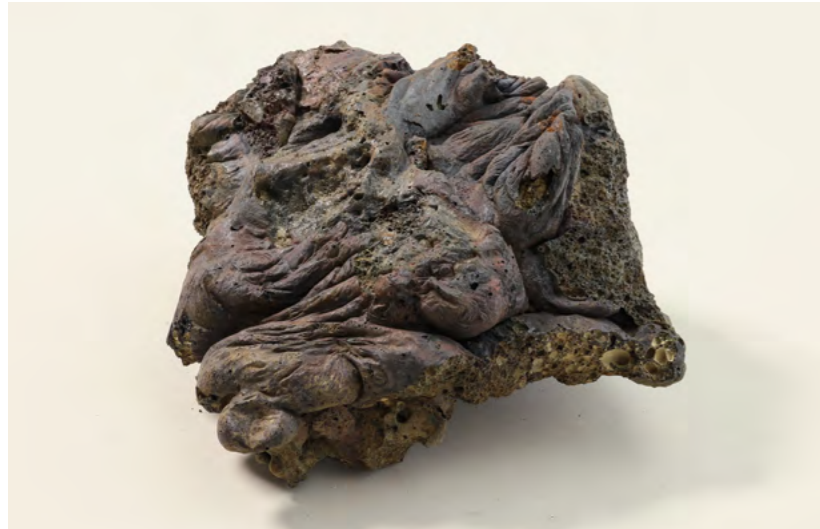
Abb. 22 Fliessschlacken als typisches Abfallprodukt der Eisenverhüttung. a Grau-dichte Schlacke (GDS); b grau-poröse Schlacke (GPS); c schwarz-glasige Schlacken (SGS). M 1:2.
