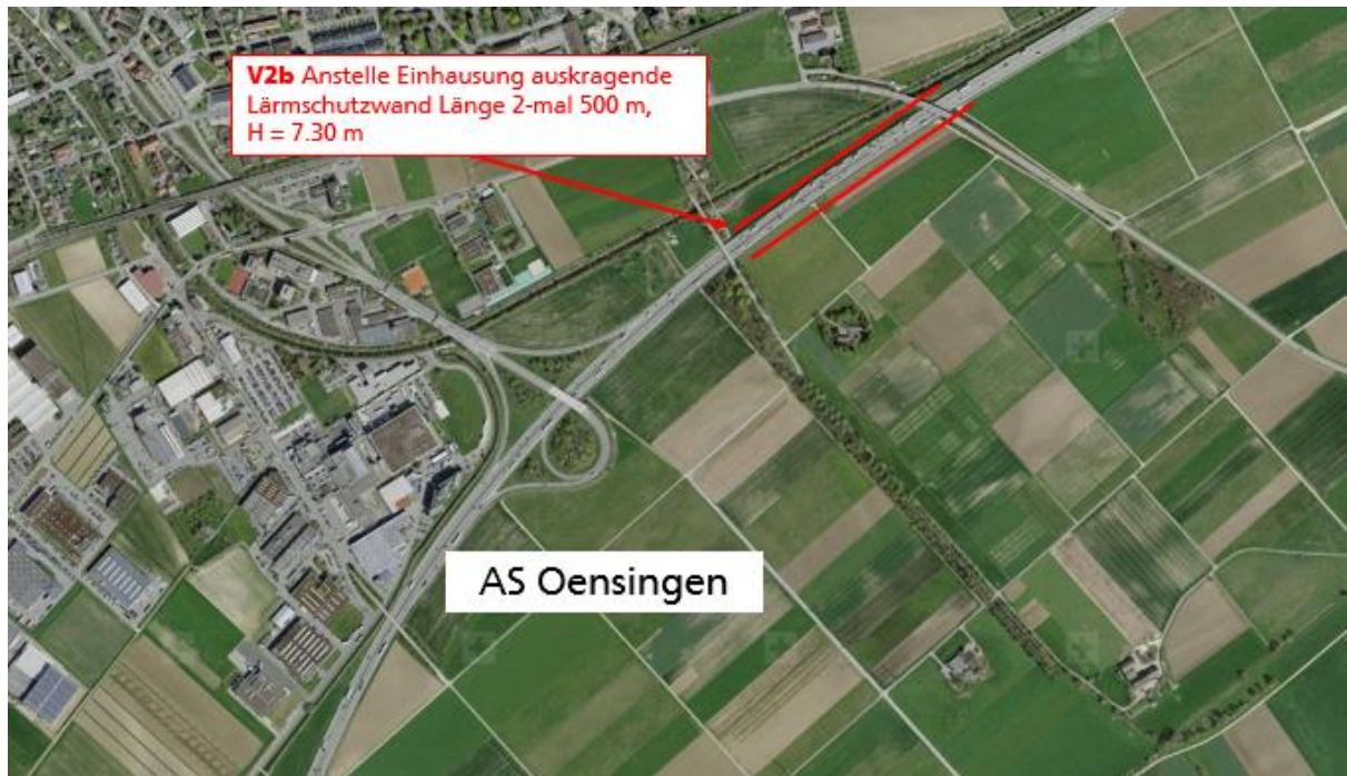
Abbildung 5: Neubau Lärmschutzwand mit Auskrragung Oensingen / Kestenholz (V2b) als Alternative zur Einhausung Oensingen (V1.2)
