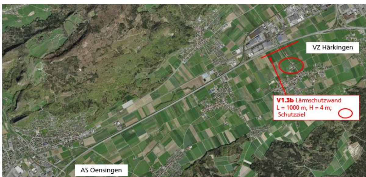
Abbildung 7: Neubau Lärmschutzwand Neuendorf Süd (V1.3b)
