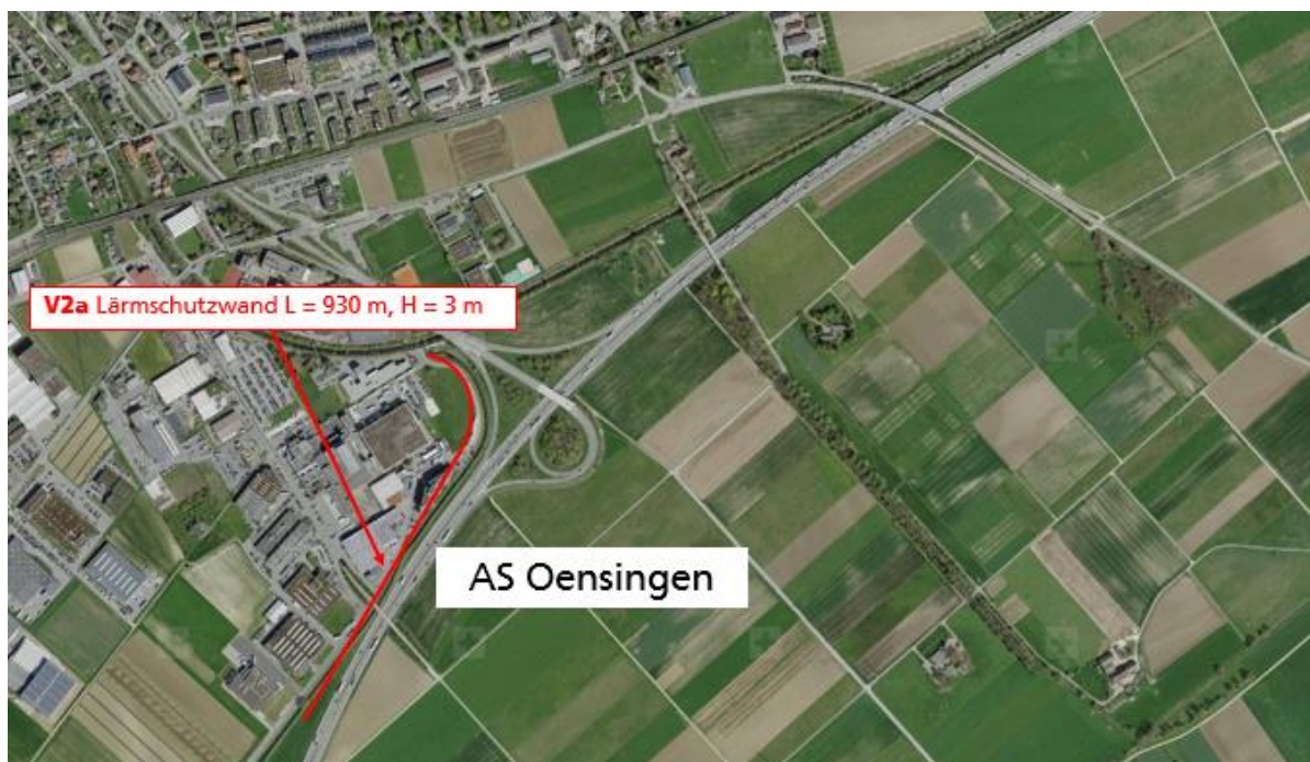
Abbildung 9: Neubau Lärmschutzwand Oensingen West (V2a)
