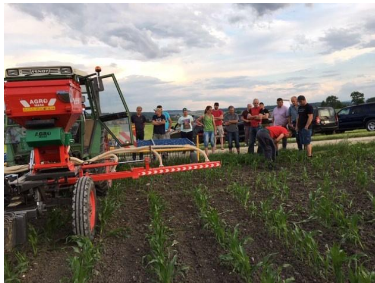
Abbildung 6: Hackstriegel im Einsatz im Mais
