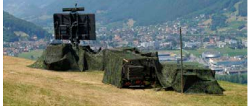
Das Taktische Fliegerradar (TAFLIR) der Schweizer Luftwaffe überwacht den unteren Luftraum
