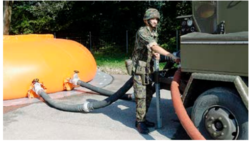
Rettungsgerätewart bedient eine Löschwasserpumpe 83
