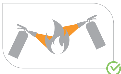
Abb. 31: Mehrere Feuerlöscher gleichzeitig einsetzen, nicht nacheinander!
