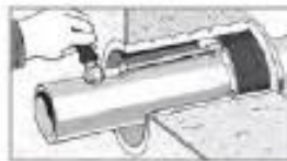
Muttern wechselseitig über Kreuz anziehen. Maximales Drehmoment beachten.
