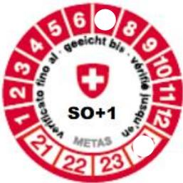
Entspricht ein Messmittel bei der Nacheichung den gesetzlichen Vorschriften, wird es mit einer Eichmarke versehen, welche die Dauer der Gültigkeit der Eichung anzeigt (im Bsp. bis Juli 2024).
