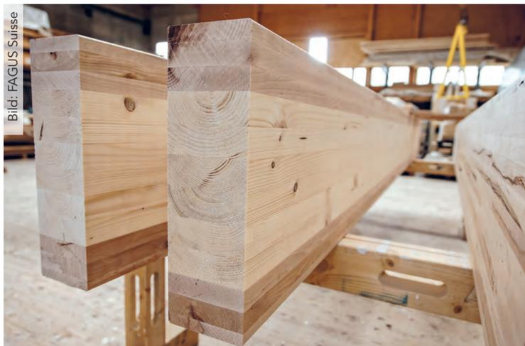
Brettschichtholz: «Stark belastete Zonen aus Laubholz, dazwischen leichtes Nadelholz»
